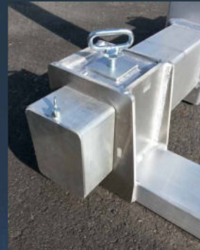
Verstellbare Gabelzinken, speziell geschweißte Profile für hohe Belastbarkeit
